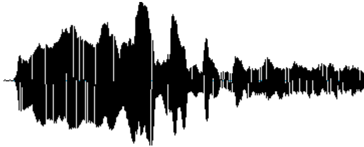
الشكل رقم (4) يبين الشكل الموجي لصوت المزمار في حال النفخ فيه نفخة ضعيفة
